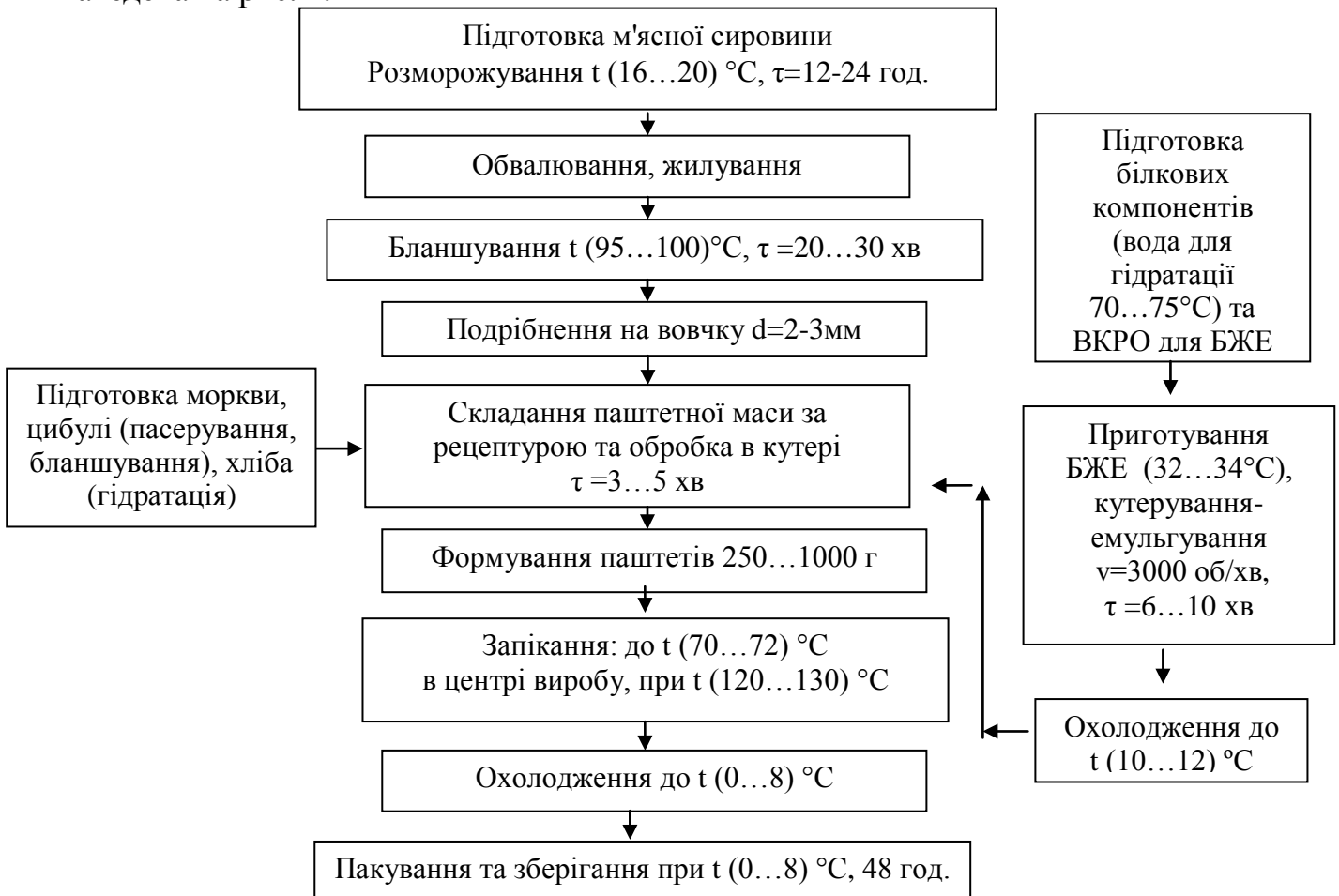
Рис. 4. Технологічна схема виробництва м'ясних паштетів.
