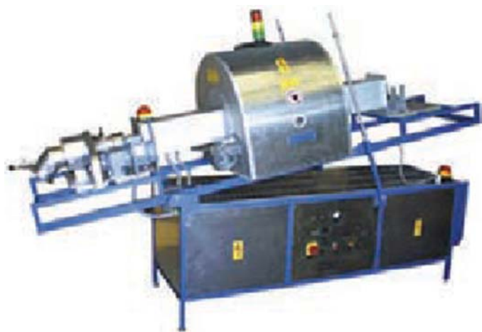
Рис. 10 Обертова трубчаста НВЧ-сушарка типу MDRT (НВЧ-потужність 2,7 кВт або 5,4 кВт)
