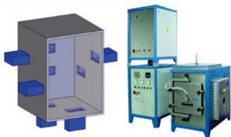
Рис. 11. Розташування магнетронів у НВЧ-камері (ліворуч) та гібридної НВЧ-печі типу МНТ-1600 (праворуч)
