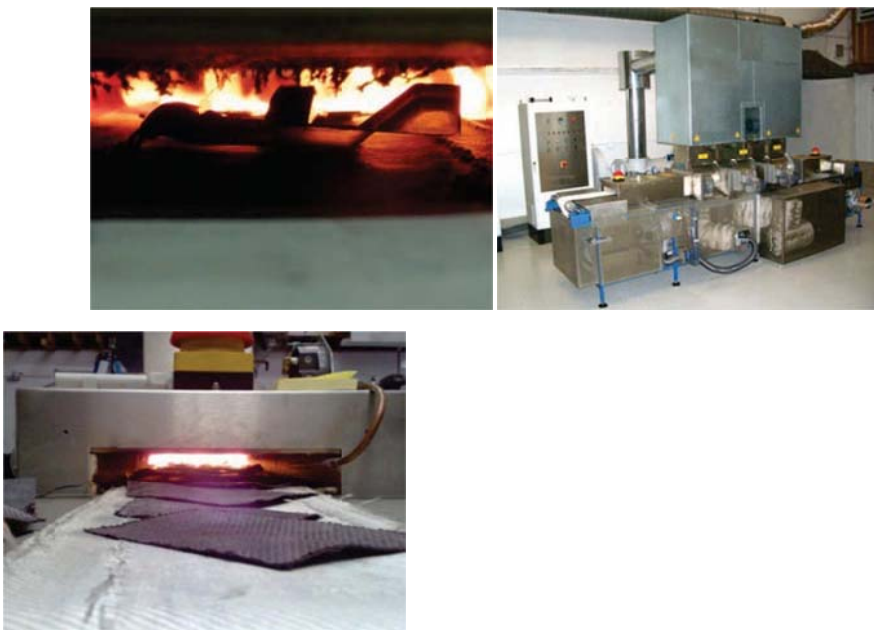
Рис. 12. Вторинне використання вуглецевих волокон (зліва і справа) та гібридних конвеєрних НВЧ-печей (середина)
