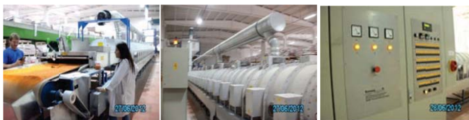
Рис. 3. Конвеєрна СВЧ піч серії MDBT 70+24/1040/210/16300 фірми LINN HIGH THERM (встановлена НВЧ- потужність 70 кВт, продуктивність 2000 – 3000 кг/год)
