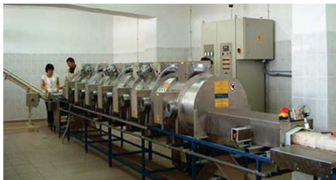
Рис. 2. Установка серії MDBT для виробництва рису швидкого приготування (встановлена НВЧ-потужність 21 кВт, продуктивність 300 кг/год)
