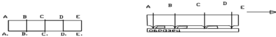
Рис. 11 б. Напрямок руху абразиву
