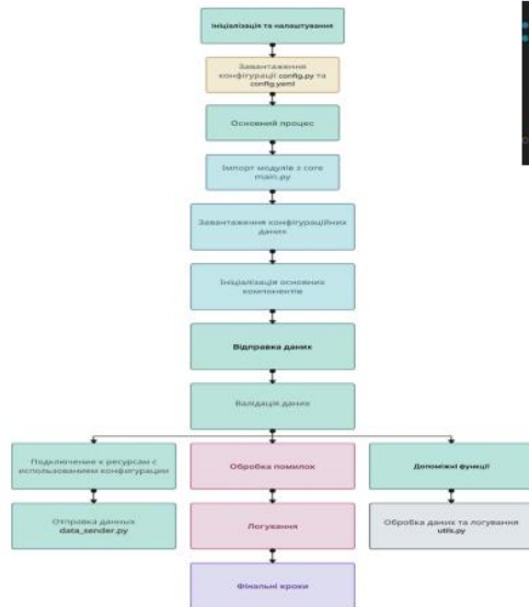
Схема процесу відправки транзакцій за допомогою скрипта для автоматизації.
