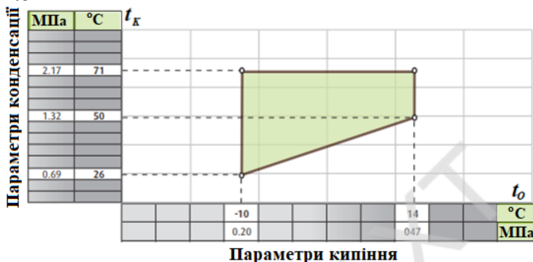
Рис. 1 – Діаграма Бенке для компресора ТМ21 при роботі на R134a
