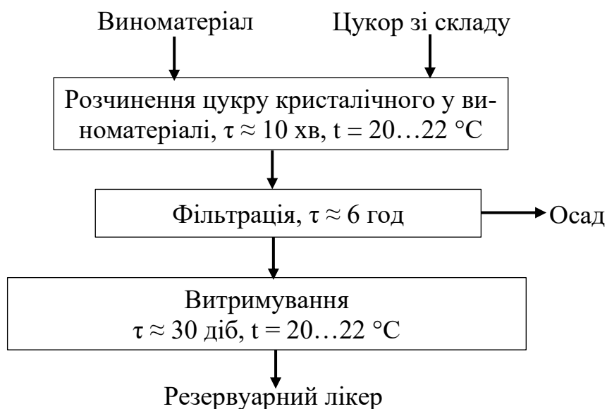
Рис. 1.5 – Схема приготування резервуарного лікеру
