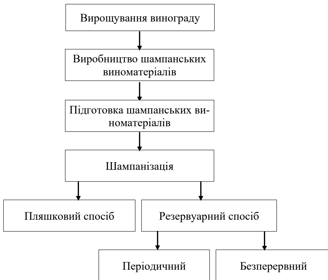
Рис. 1.1 – Етапи виробництва шампанських вин
