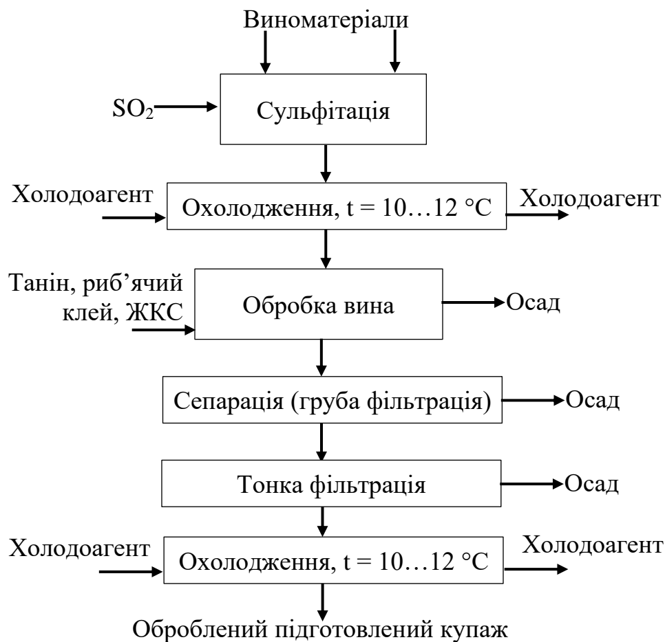
Рис. 1.3 – Схема обробки виноматеріалів
