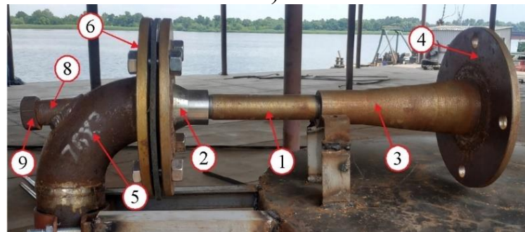
Рис. 2. Експериментальний термопресор: а) – складальне креслення; б) – фото; 1 – камера випаровування; 2 – конфузур; 3 – дифузур; 4, 6 – фланці; 5 – приймальна камера; 7 – форсунка; 8 – патрубок для монтажу трубки подачі води; 9 – контргайка; 10 – трубка для фіксації форсунки
