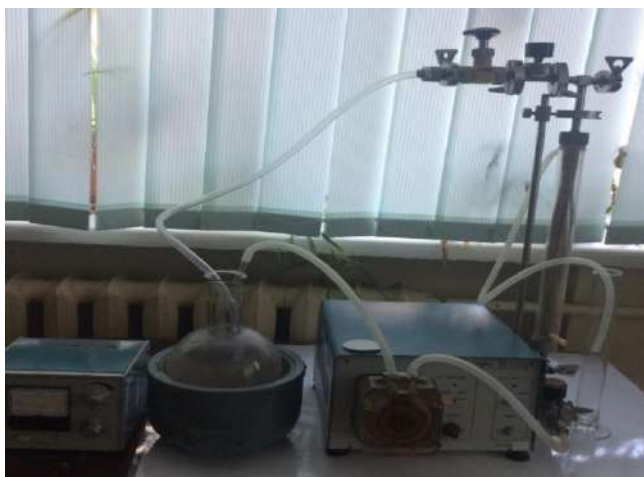
Рис. 2.2. Лабораторна мембранна установка для ультрафільтрації УПЛ-0,6
