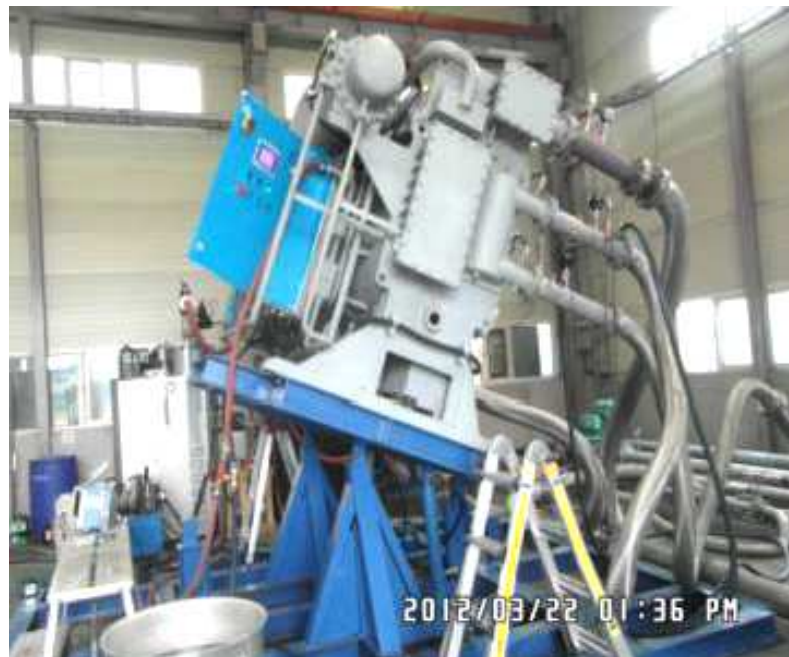
Рис. 1.11. Стенд для проведення випробувань роботи АБХМ фірми "BPC Group Engineering", що моделює суднові умови
