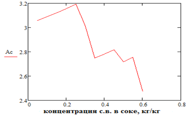
Рис. 6.8. Залежність A_s від концентрації соку, при скоригованому розрахунку в'язкості.
