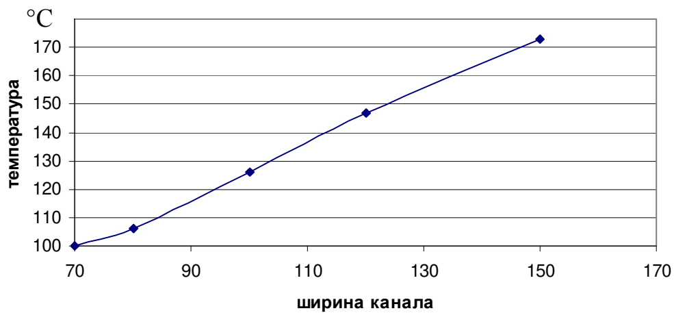
Рис. 9.8 Залежність температури відхідних газів від ширини каналу
