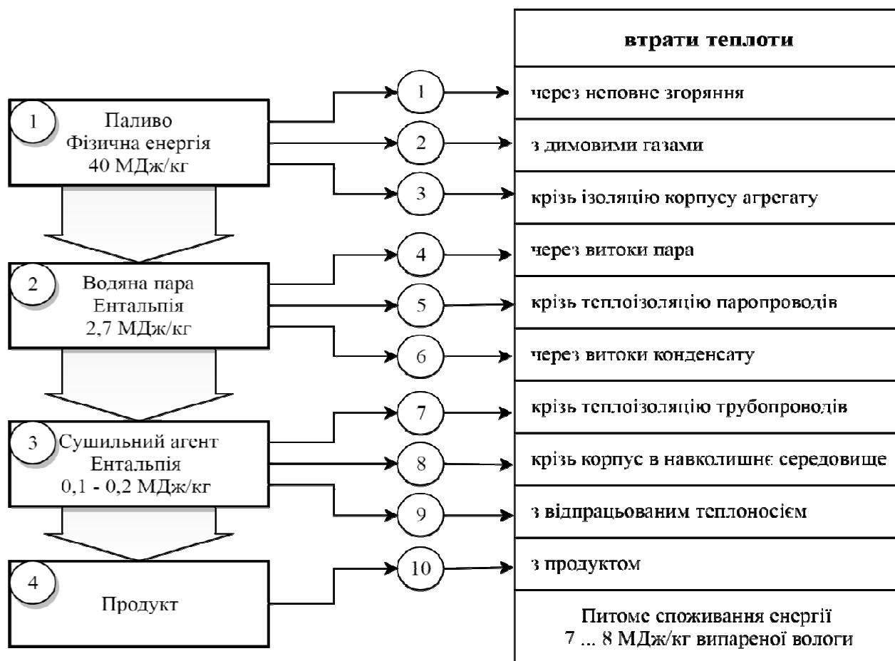
Рис. 2.7. Енерготехнологічна схема конвективного сушіння харчових продуктів.
