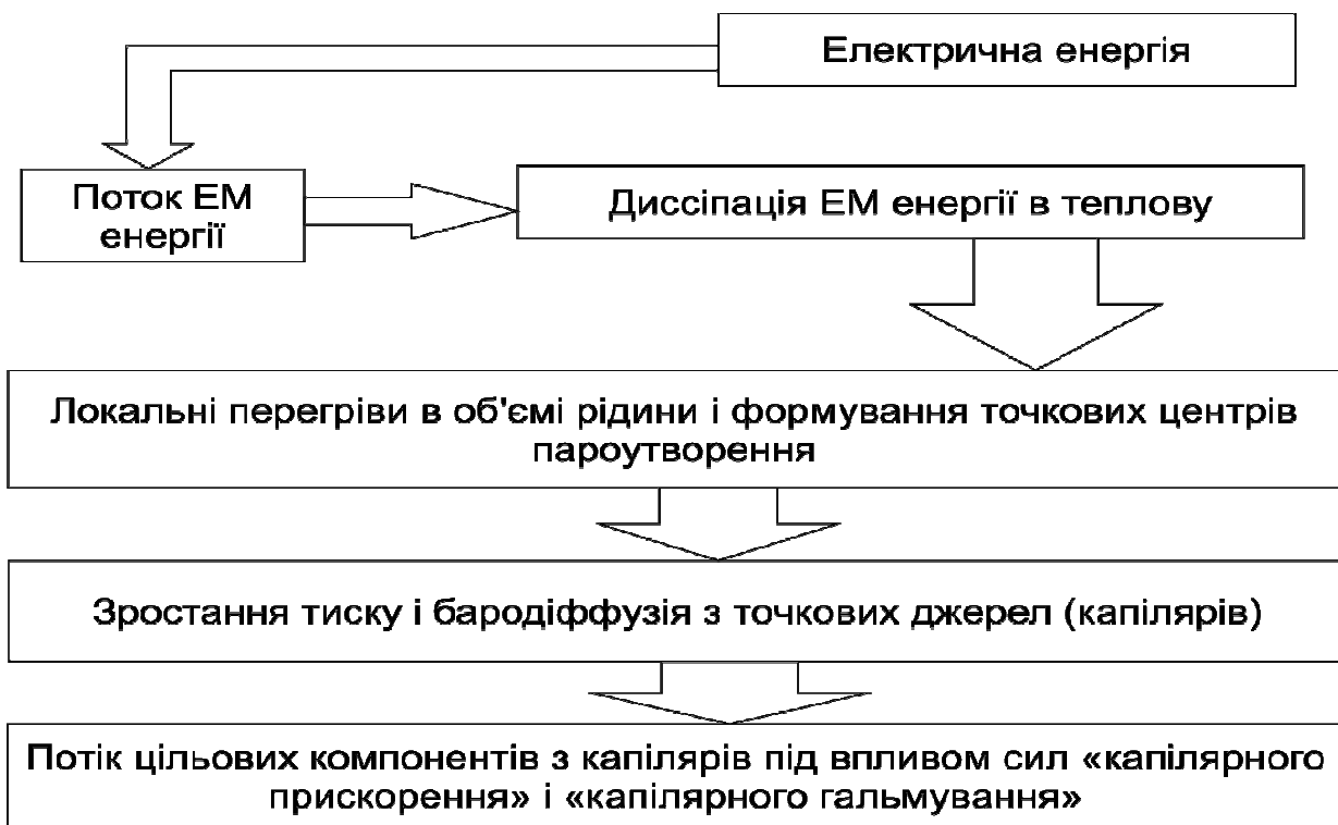
Рис. 4.4. Електротеплофізична модель пов'язаних процесів масо переносу
