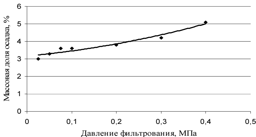
Рис. 2 – Зависимость массовой доли осадка в фильтрате осахаренной водно-картофельной смеси от давления фильтрования
