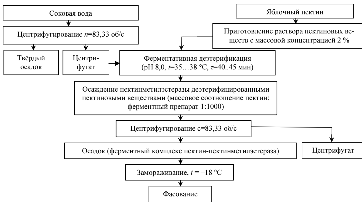
Рис. 3 – Принципиальная схема получения ферментного препарата с пектинметилэстеразной активностью
