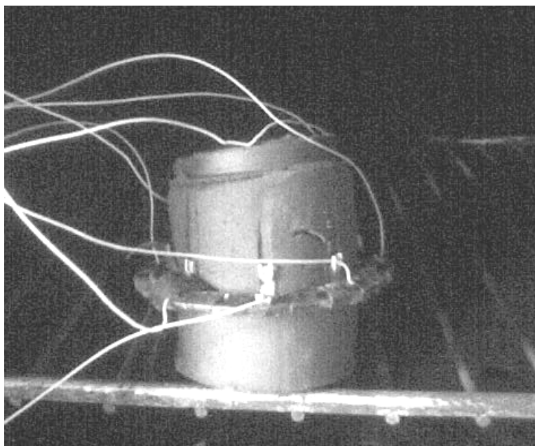
Рис. 2 – Циліндричний зразок виготовлений із цегли-сирцю з накладеними електродами
