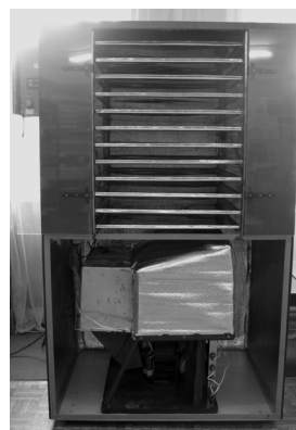
1 – сушильна камера; 2 – випарник; 3 – збірник конденсату; 4 – компресор; 5 – конденсатор; 6 – дросель
