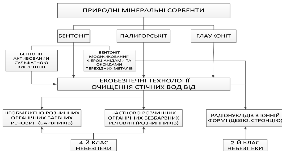
Рис. 4 – Класифікація використання природних та модифікованих сорбентів в технологіях очищення стічних вод від забрудників 2-4-го класу небезпеки
