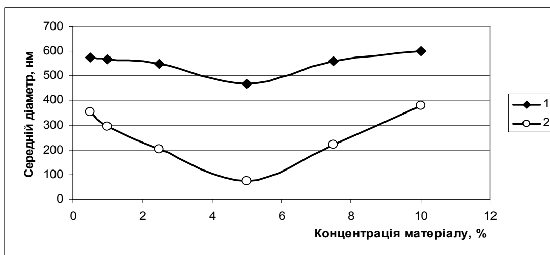
Рис.1. – Залежність середнього діаметру наночасток від концентрації матеріалу отриманого з попередньою обробкою фосфоліпідів використанням в якості екстрагента:
