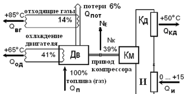
Рис. 1 – Схема теплонасосной установки с газовым двигателем-генератором
