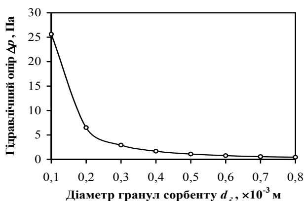
Рис. 4 – Залежність гідравлічного опору шару сорбенту адсорбера-десорбера від розміру гранул
