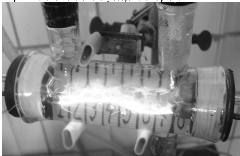
Рис. 2 – Експериментальна ємність 1 при досягненні критичного значення теплового потоку ( q_{кр}=1,2 \cdot 10^6 Вт/м 2 )
